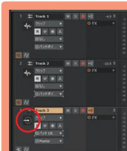
トラックのアイコンが変わってバストラックになりました。バストラックとはインプットがパッチポイントに設定されたものなので、オーディオトラックのインプットを設定することで、そのトラックはバストラックになります。
